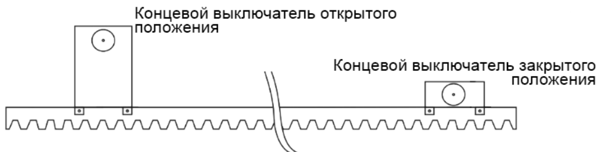
Рис. 12. Схема установки магнитных концевых выключателей на зубчатую рейку
